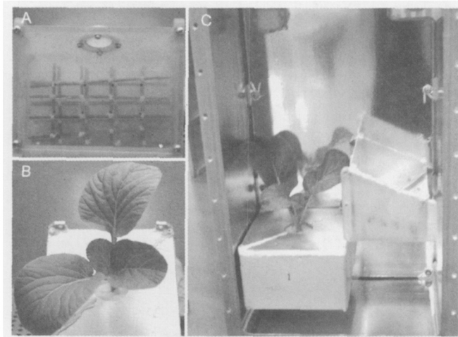
图 1 “实践八号”育种卫星发射前植物样品及其在空间植物培养箱中的安装。A: 种子; B: 幼苗; C: 空间植物培养箱内部植物培养单元
